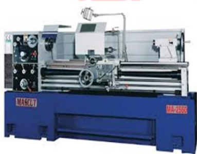
Hình 1-1: Máy tiện vạn năng
